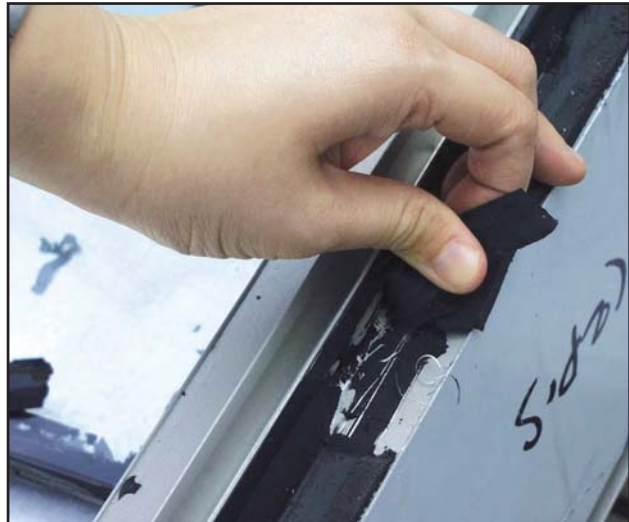
Ablösungen, Deglazingtest negativ.
