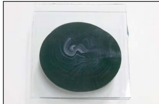
Negatives Testergebnis = unzureichende Mischung
