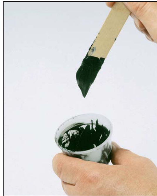
Das Material zeigt ein gummiartiges Verhalten: Topfzeit erreicht
